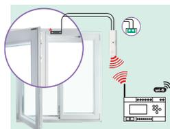
APPLICAZIONE CONSIGLIATA QUANDO IL TRASMETTITORE RF E LA CENTRALINA POLARIS 3X - 4X RISULTANO FUORI PORTATA RF. UN CONTATTO FINESTRA CABLATO (**NON FORNITO DA TECNOSYSTEMI\***), ANDÀ COLLEGATO ALLA MORSETTIERA DISPONIBILE NEL MODULO RADIO DEL TRASMETTITORE RF IL QUALE AVRÀ IL COMPITO DI TRASMETTERE VIA RF ALLA CENTRALINA IL SEGNALE DI APERTURA O CHIUSURA DELLA FINESTRA.
